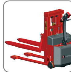
Timetæller, batteriindikator og fejlfinding i samme instrument. Motorbremse.
