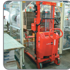
Manøvreedygtighed sikres ved kort byggelængde, stor drejevinkel, tvangsstyrede hjul og lav egenvægt.
