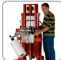
Rotation foretages manuelt, med eller uden gear.
