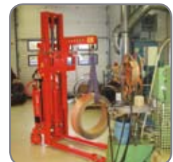
Metalruller løftes ind i en stansemaskine.
